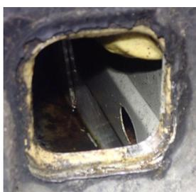
An den linken Schweller kommt man zusätzlich von hinten, durch einen rechteckigen Stopfen im Radkasten. Durch das runde Loch rechts im Bild erreicht man die innere Kammer des (linken) Schwellers.
