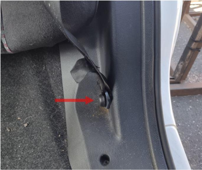
Über dem hinteren Ende der äußeren Kammern befinden sich die Heuliez-Ecken. Man erreicht sie am elegantesten, indem man die untere Befestigung des hinteren Gurts abschraubt und ein Loch bohrt (maximal 9,5 mm).
