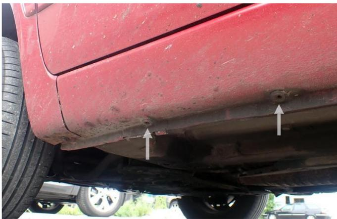
Die Schweller haben eine äußere und eine innere Kammer. Die Trennlinie ist von außen an der unteren, geraden Kante erkennbar. Die äußeren Kammern erreicht man durch die gezeigten Stopfen (beidseitig). Vorsicht, die Stopfen fallen leicht nach innen. Es genügt, einen Stopfen pro Seite zu entfernen.
